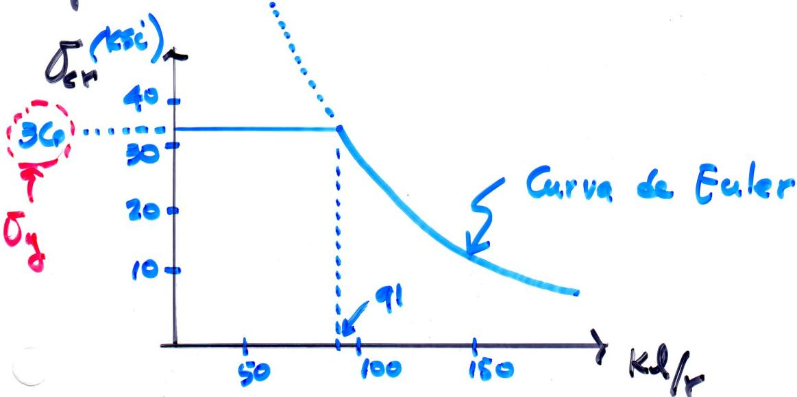
Curva de Euler para el Acero Estructural ( $\sigma_y = 36 \text{ ksi}$ ,  $E = 29,000 \text{ ksi}$ )
