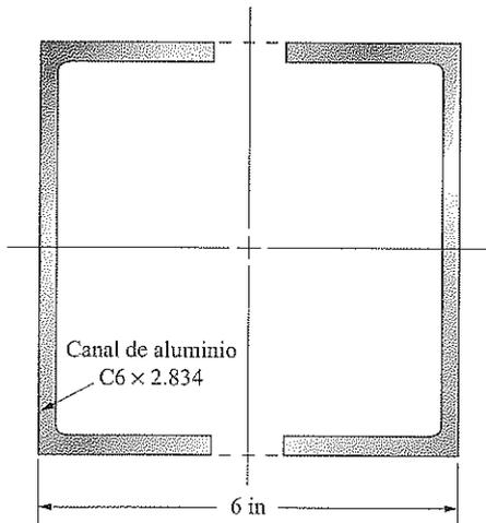
FIGURA P11-14 Sección transversal de columna compuesta del problema 11-14.
