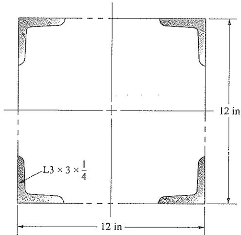
FIGURA P11-13 Sección de columna compuesta del Problema de ejemplo 11-13.
