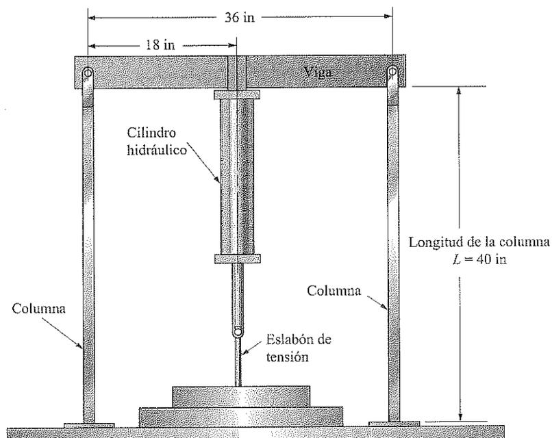
Nota: El cilindro jala hacia arriba el eslabón de tensión y hacia abajo la viga con una fuerza de 3000 lb.
