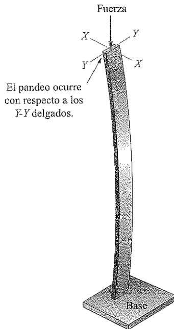
Ahora cambiemos el procedimiento un poco. Parece que la regla de un metro tiende a pandearse cerca de su punto medio, es decir, en el punto situado a 0.50 m. ¿Qué pasaría si utilizamos algún soporte lateral a ambos lados de dicho punto? Trate de hacerlo si dispone de una regla de un metro. Coloque sus dedos a ambos lados para limitar la tendencia a pandearse hacia fuera. Ahora empujela de nuevo hacia abajo como ya lo había hecho antes.
