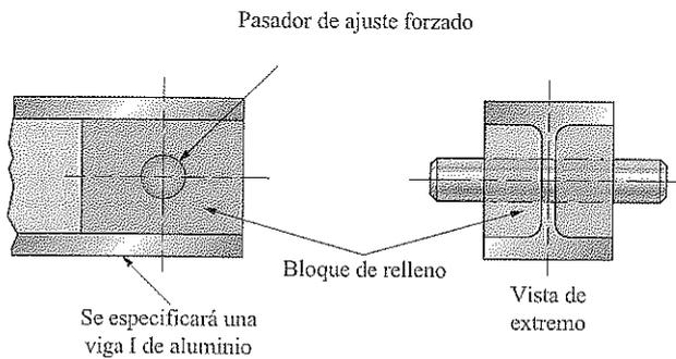
FIGURA P11-25 Conexión de un extremo de la viga I del problema 11-25.
